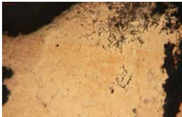
تصویر ۴. در ریزساختار نمونه ظرف فلزی شماره یک (1-124TA) خطوط لغزش زیادی دیده می‌شود که نشان دهنده چکش کاری سرد بعد از بازپخت است و خوردگی‌های مرزدانه‌ای نیز با بزرگنمایی ۲۰۰ برابر مشاهده می‌شود. مأخذ: آرشیو نگارندگان.
