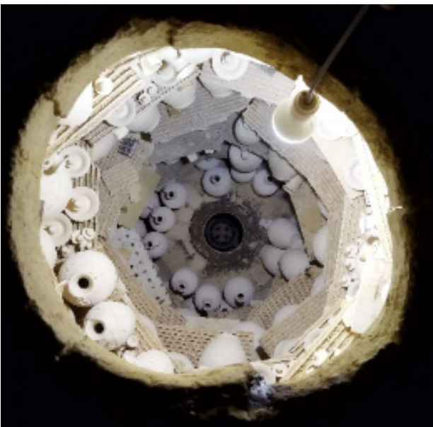
تصویر ۸. کوره سنتی سفالمنند. لوله‌های سرامیکی که به منظور نگه‌دارنده صفحه‌های سرامیکی داخل بدنه کوره جاگذاری شده است. مأخذ: آرشیونگارندگان.
